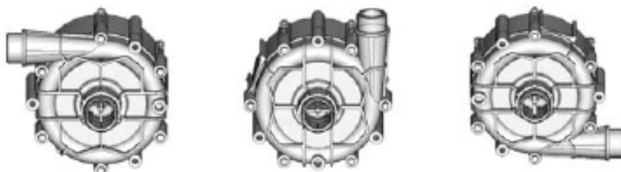
Рис. 8.3.1 В - Допустимое положение гидравлического блока
