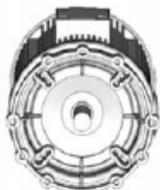
Рис. 8.3.1 А - Правильное расположение фонаря на фланце
